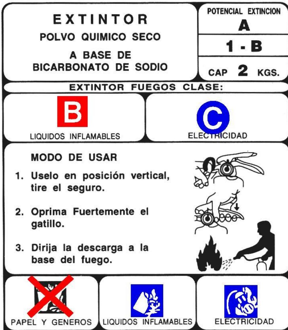
Las instrucciones de uso, deben ser proporcionadas por el fabricante o importador mediante un rótulo o etiqueta firmemente adherida en la parte del cilindro que resulte más visible cuando el extintor se encuentra en su posición y ubicación normal.
