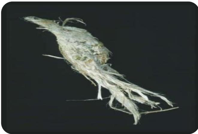
Como principales propiedades de la estructura fibrosa y cristalina de los asbestos podemos mencionar resistencia al calor (fuego directo); resistencia a la abrasión; resistencia a agentes químicos; aislante térmico y acústico; baja conductividad eléctrica; y bajos costos.
